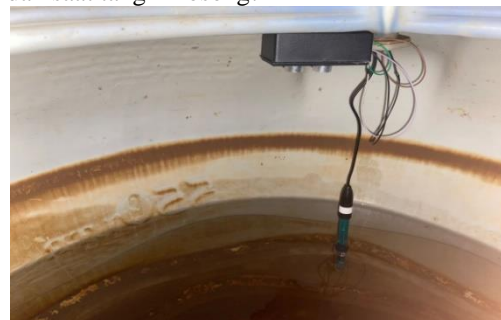
Gambar 2. Implementasi Sensor Ultrasonik Pada Tangki
