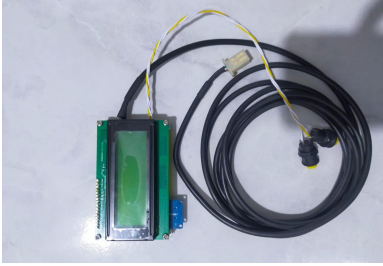
Gambar 13 OBD Board Tampak Atas Dengan LCD dan Kabel
