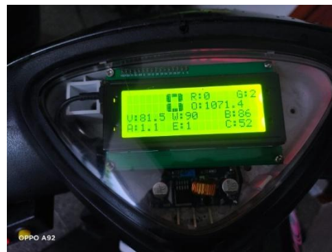
Gambar 2. OBD Board Yang Terpasang di Dashboard Kendaraan Listrik
