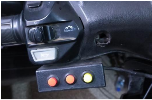
Gambar 3. Tombol Reset untuk Wh meter dan ODO meter
