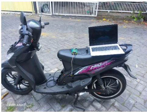
Gambar 4. Software Debugging ke OBD pada kendaraan Listrik
