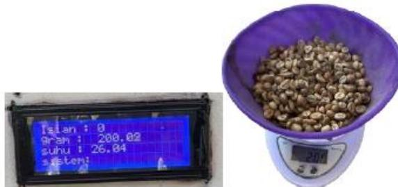
Gambar 7. Perbandingan LCD sebagai output Sensor dan timbangan.
