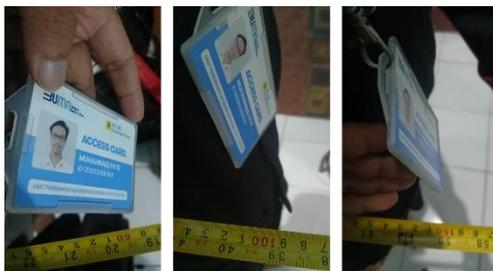
Gambar 7. Pengujian *Tag* Digantung Menggunakan Lanyard
