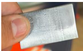
Gambar 8. Spesimen sesudah dilakukan proses pemolesan
