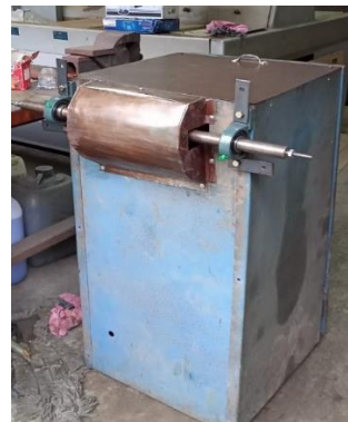
Gambar 5. Bentuk Mesin Poles Setelah Proses Perakitan
