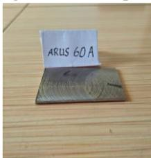
Gambar 5 Spesimen uji arus pengelasan 60 A
