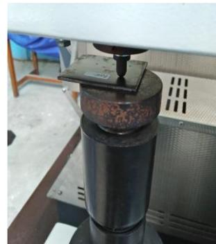
Gambar 3 Posisi spesimen pada *anvil*
