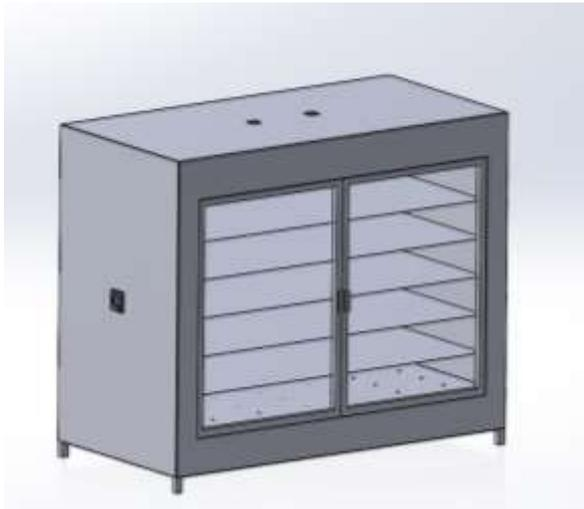
Gambar 2 Desain mesin oven pengering kerupuk
