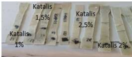
Gambar 3. Spesimen untuk uji tarik dengan beberapa variasi komposisi katalis
