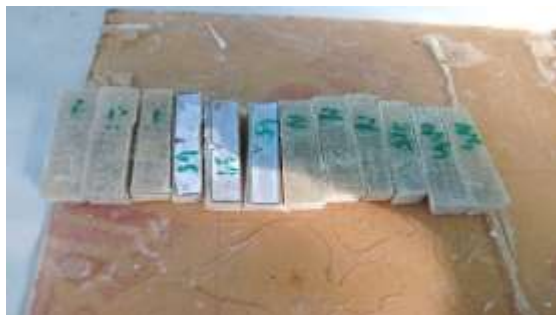
Gambar 4. Spesimen untuk uji impact dengan beberapa variasi komposisi katalis
