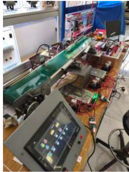
Gambar 1. Prototipe simulator konveyor penyortir logam dan non-logam.
