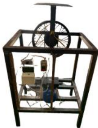
Gambar 4. Hasil simulator pendeteksi kerusakan bearings
