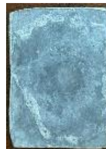
Gambar 12. Minggu ke-4 spesimen Inhibitor NaOH
