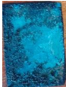
Gambar 7. Minggu ke-3 spesimen Inhibitor K_3Fe(CN)_6
