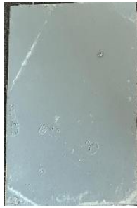
Gambar 13. Minggu ke-1 spesimen non Inhibitor NaCl
