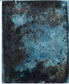
Gambar 6. Minggu ke-2 spesimen Inhibitor K_3Fe(CN)_6
