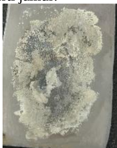
Gambar 24. Minggu ke-4 kondisi Spesimen Non Inhibitor NaOH
