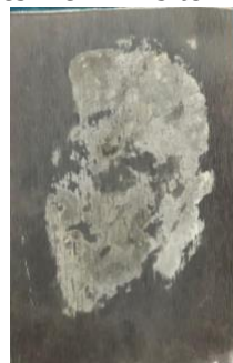
Gambar 9. Minggu ke-1 spesimen Inhibitor NaOH
