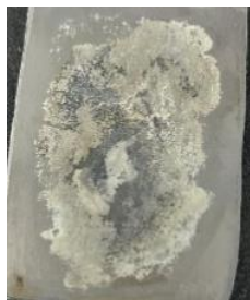
Gambar 21. Minggu ke-1 kondisi Spesimen Non Inhibitor NaOH
