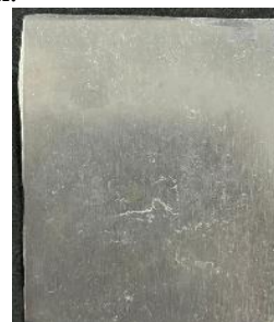
Gambar 3. Minggu ke-3 spesimen Inhibitor NaCl
