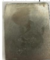
Gambar 2. Minggu ke-2 spesimen Inhibitor NaCl
