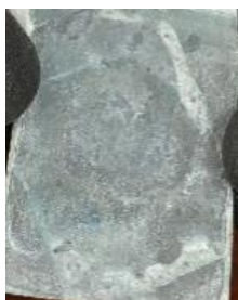
Gambar 22. Minggu ke-2 kondisi Spesimen Non Inhibitor NaOH
