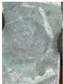
Gambar 23. Minggu ke-3 kondisi Spesimen Non Inhibitor NaOH
