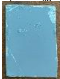
Gambar 16. Minggu ke-4 spesimen non Inhibitor NaCl
