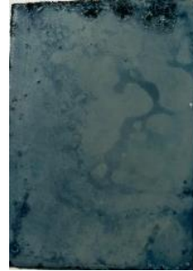
Gambar 17. Minggu ke-1 Spesimen Non Inhibitor K 3 Fe (CN) 6
