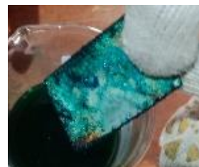
Gambar 20. Minggu ke-4 Spesimen Non Inhibitor K 3 Fe (CN) 6
