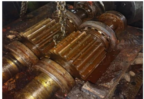
Gambar 2. Perawatan Pada Sistem Pelumasan Gearbox
