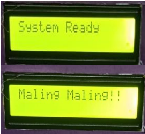
Gambar 6. Tampilan Peringatan dari Sensor PIR pada LCD
