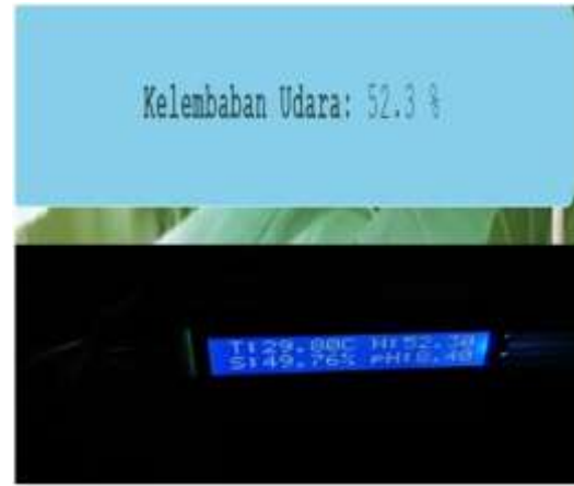
Gambar 8. Kesesuaian Nilai Kelembaban Udara Pada Tampilan Sensor di LCD (bawah) dan Hasil di Sistem (atas)
