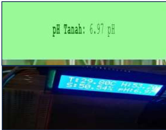
Gambar 13. Kesesuaian Nilai pH Tanah Pada Tampilan Sensor di LCD (bawah) dan Hasil di Sistem (atas)
