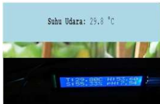
Gambar 5. Kesesuaian Nilai Suhu Udara Pada Tampilan Sensor di LCD (bawah) dan Hasil di Sistem (atas)
