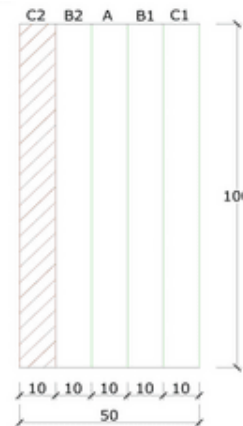
Gambar 13. Lokasi Area yang di uji Pada C2
