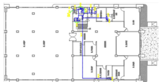
Gambar 15. Perencanaan Sistem Plambing Air Bersih Lantai 2
