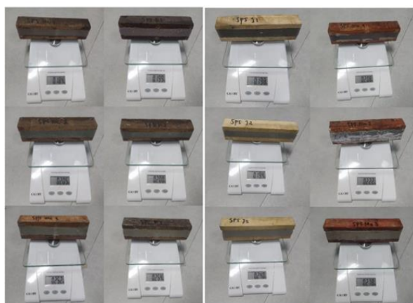
Gambar 10. Pengukuran Densitas Untuk Spesimen Casting
