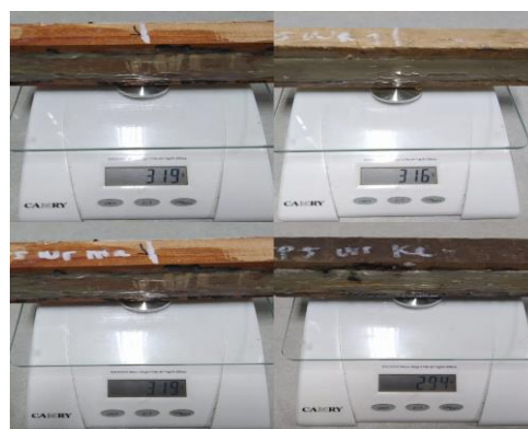
Gambar 11. Pengukuran Densitas Untuk Spesimen Hand Layup
