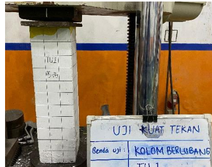
Gambar 4 Pengujian Kuat Tekan Kolom
