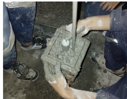
Gambar 2 Pembuatan Benda Uji Kolom
