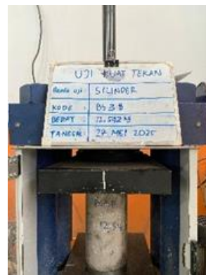
Gambar 8. Pengujian Beton Silinder Menggunakan CTM
