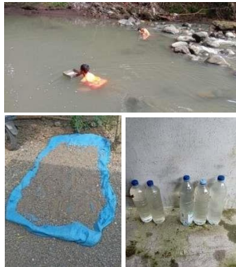
Gambar 7. Proses Pengambilan Sampel Sedimen dan Hasil Sampel Sedimen
