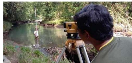
Gambar 5. Proses Pengukuran Batimetri Sungai Secara Manual
