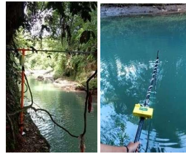
Gambar 4. Proses Pengambilan Data Water Level dan Water Flow dengan Suhu dengan Alat Hidrometri Berbasis Sensor [17]
